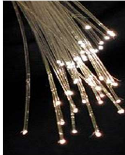
Fig. (1-1). a). optical fiber diameter: 8 -200 \mu\text{m}
